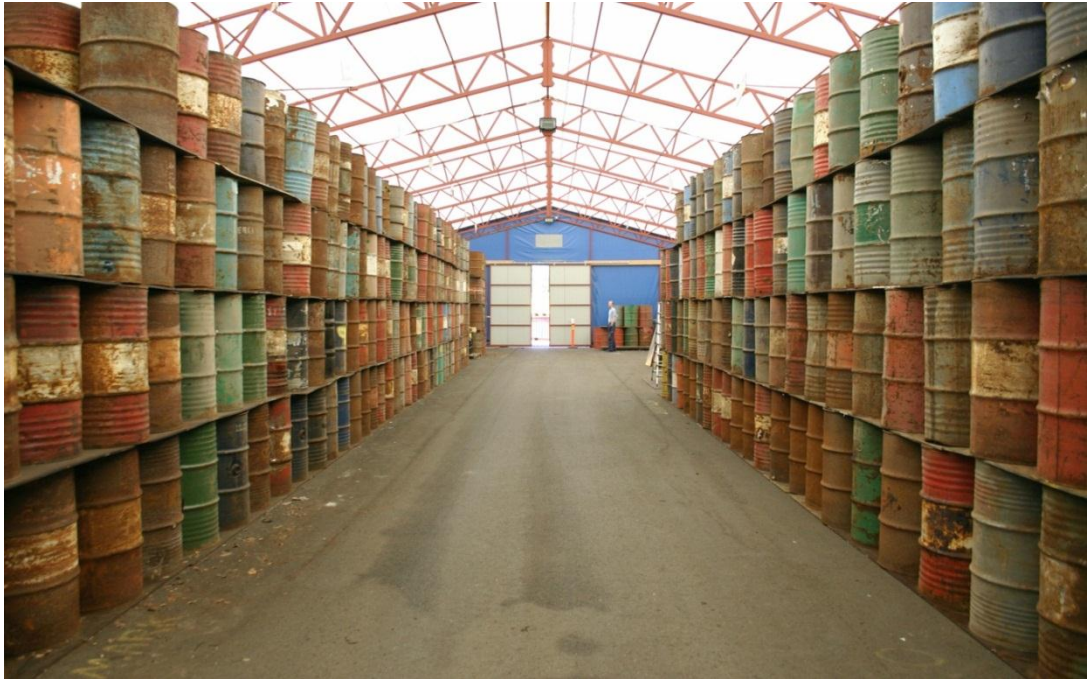
Bild 3 Anläggningen AUT strax innan röntgenprojektet påbörjades. I anläggningen förvarades 2 200 avfallsposter med betongkringgjutet avfall mellan år 2000 och 2010. Till höger om mittgången ses de 800 fat som innehåller betongkringgjutna askor och till vänster ses de 1 400 fat med betongkringgjutna sopor och skrot som hanterades i röntgenprojektet. Samtliga fat i AUT var inför projektet i avsaknad av extra ytteremballage.
